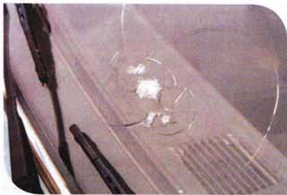
Rotura de cristal laminado
