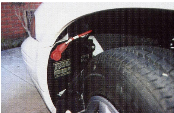
Ubicación de batería en vehículo.
